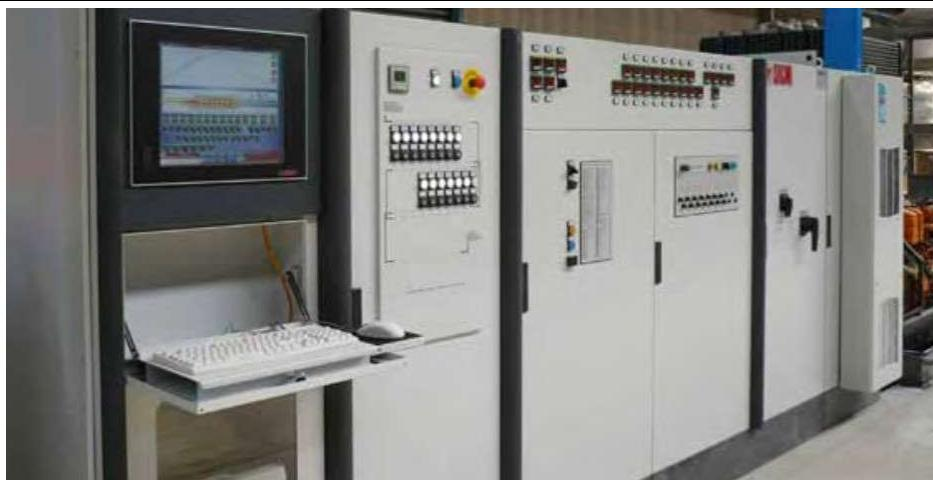
scopo appunto di facilitare l'operatore nella gestione di un forno a rulli per la produzione di ceramica. La gestione è affidata a un PLC, per l'acquisizione dei dati sul "campo" e il relativo controllo, e ad un PC industriale come interfaccia uomo-macchina; tramite il PC è possibile controllare, analizzare e modificare ogni parte della macchina.
